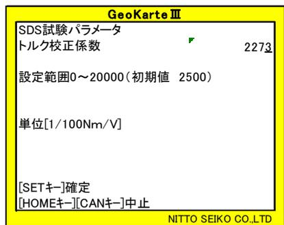
(7) トルク校正係数を100倍した値を入力し、[SETキ]を押して確定します。
