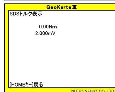
(8) 下図のようにトルク測定ロッドにトルクレンチを接続し、矢印の反時計方向にトルクを加えます。トルクを加えるとコントローラ画面に加えられたトルク値及び、電圧値が表示されます。
