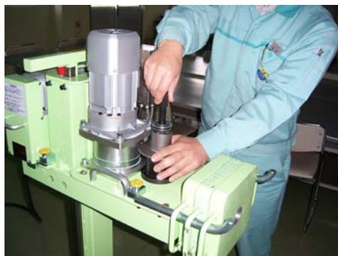
(3) 右図のようにチャックを開き、トルク測定ロッドを上から差込み取り付けます。
