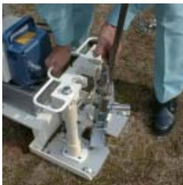
( 1 1 ) チャックユニットを引き上げ、スクリューポイント地面から抜き取ってください。
