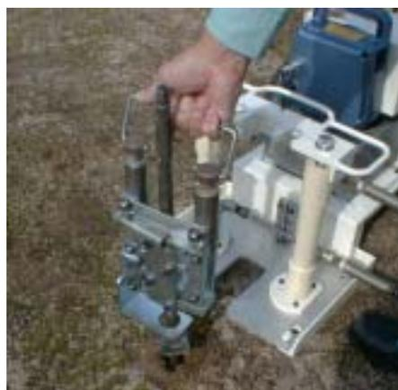
( 4 ) 右手で引抜装置本体を持ち、チャックユニットを上下させ装置本体にチャックユニットを装着してください。
