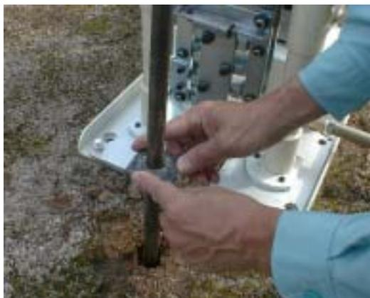
( 3 ) チャックユニットを引抜装置本体から外しロッドに通してください。
